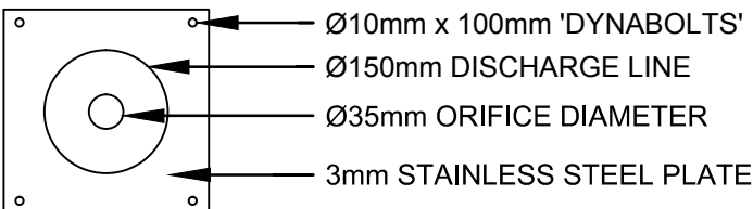
ORIFICE PLATE 2 DETAIL N.T.S.
