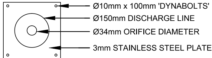
ORIFICE PLATE 1 DETAIL N.T.S.
